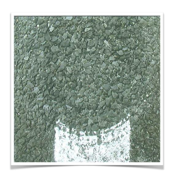
消去後においても、骨材の剥離損傷はなく、舗装体に与える影響は無いことが確認されます。
